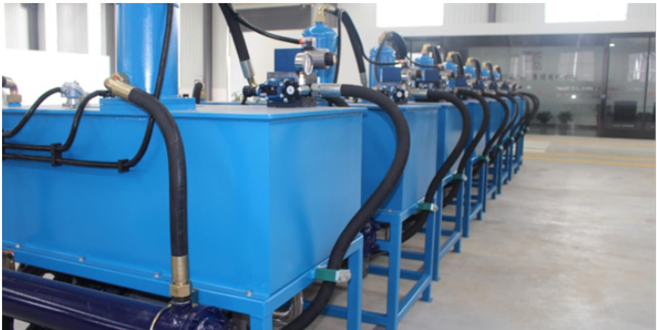
购买扬州四启节能泥浆泵的客户，在收到整套设备后，应注意泵体必须安装稳固，用预埋件固定，不得用膨胀螺丝，并且设备应安装在宽敞的室内，有一定的散热空间，有灯光照明，如需安装在室外，一定要在前期技术沟通中说明，提前在现场搭建好遮雨棚或通过洽谈，安装防晒、防雨、防水设施。泵体进料总管口径应大于泵的进料管口口径至少一个规格以上，在安装管道时徐安装稳固，不可以悬空。在进料管道上应安装2目的过滤网，防止大颗粒杂质进入泵缸体内（单向阀允许通过大粒径为 $20\text{mm}$ ）
